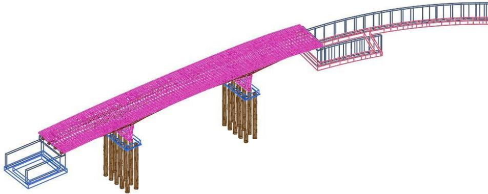
Figura 3 Modello esportato da Tekla Structures come Mesh poliedrica
